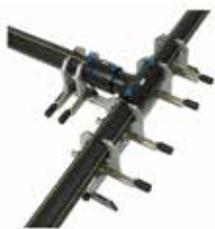
**Ausricht- und Haltewerkzeug mit Zange
